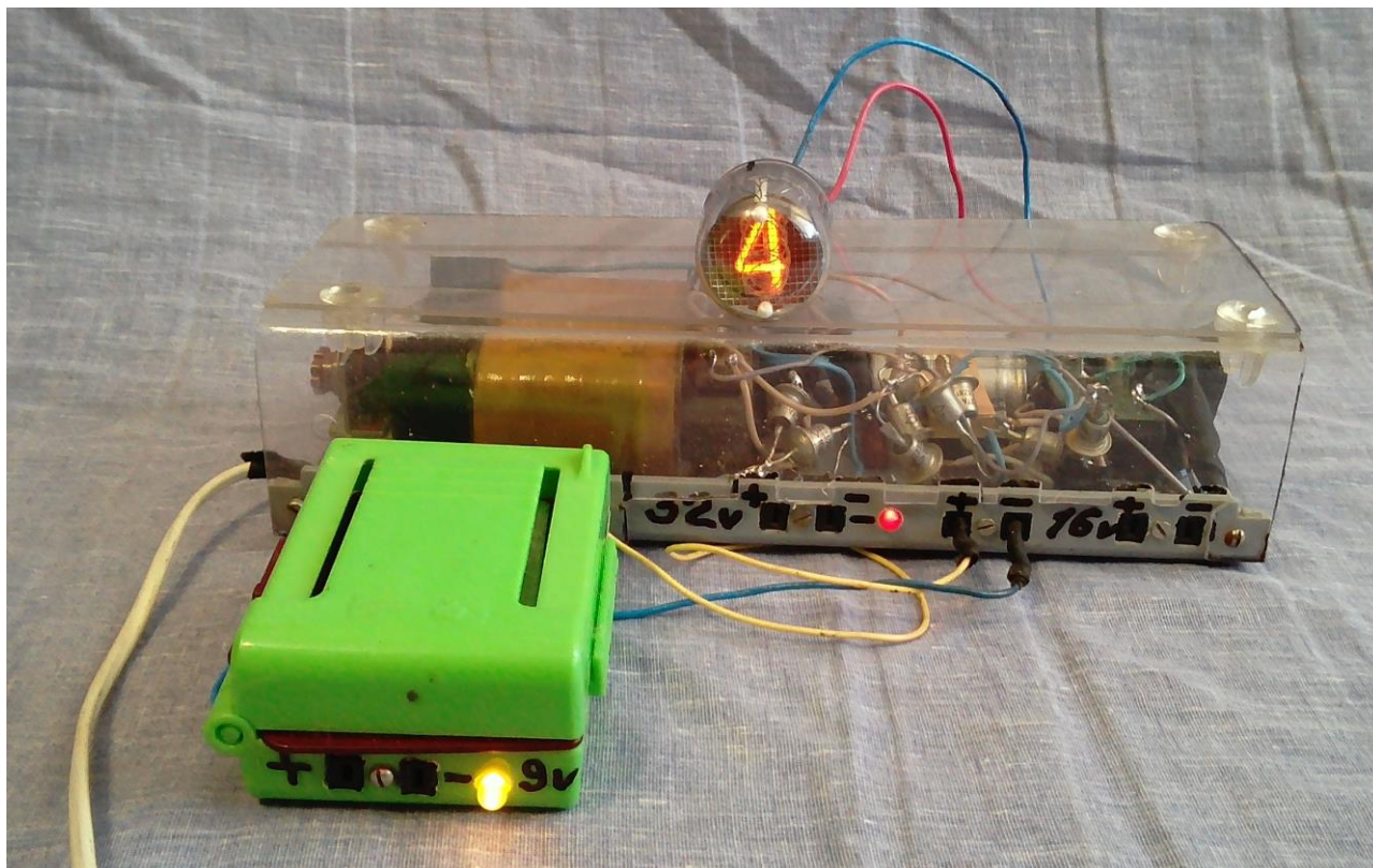
Фото 1. Стенд- п'ять типів випрямлячів змінного струму, стабілізатор напруги на \pm 9 В, індикатор ИН- 4
